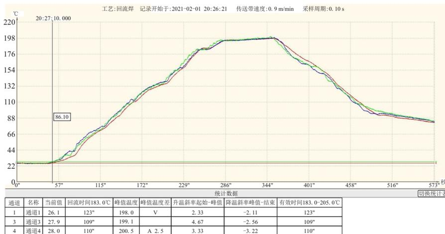
图6 50 W T/R 试验样件焊接曲线
